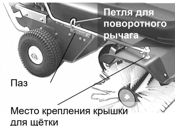
Протяните поворотный рычаг через петлю и подведите его к месту крепления.
